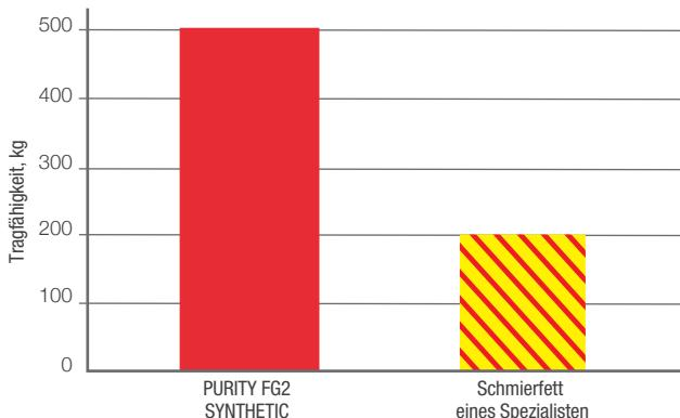
PURITY FG2 SYNTHETIC Grease hat eine höhere Tragfähigkeit als andere für die Lebensmittelindustrie zugelassene Schmierfette anderer Anbieter. Es ist ideal zur Anwendung in der Lebensmittelherstellung, die mit einer stärkeren Belastung einhergeht.
